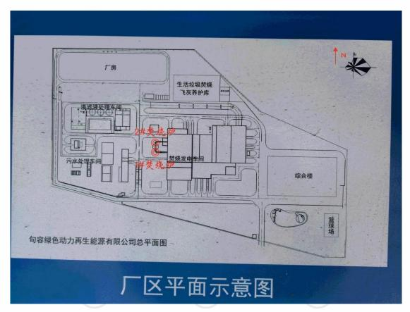
说明:◎焚烧炉废气采样点
