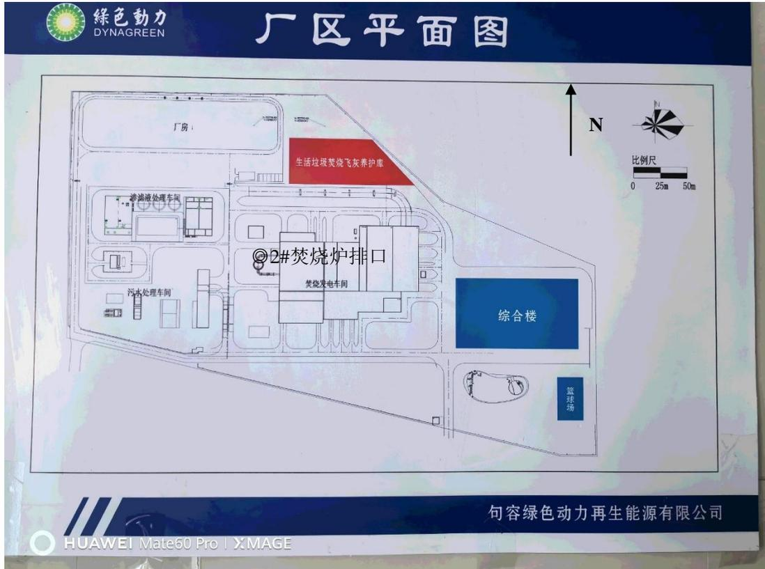
说明：◎焚烧炉废气采样点
