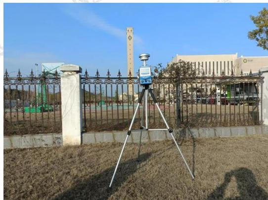
○废气(无组织)采样点 - 厂界下风向监控点 2#
