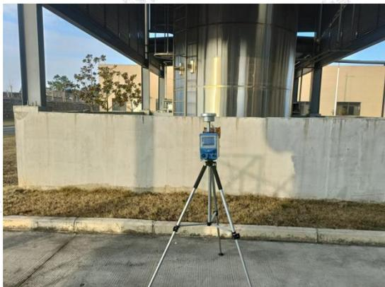
○废气(无组织)采样点 - 罐区上风向参照点
