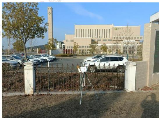
○废气(无组织)采样点 - 厂界下风向监控点 3#
