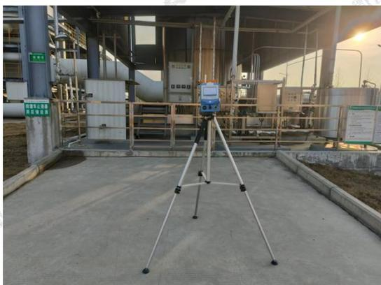
○废气(无组织)采样点 - 罐区下风向监控点
