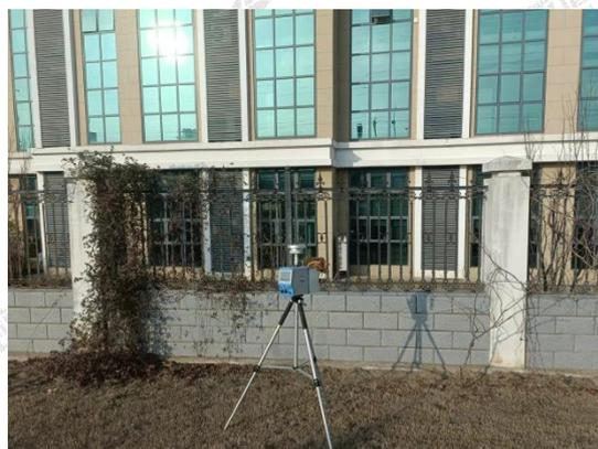
○废气(无组织)采样点 - 厂界下风向监控点 4#
