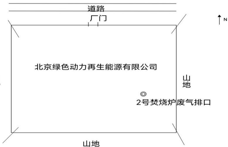
说明：◎焚烧炉废气采样点
